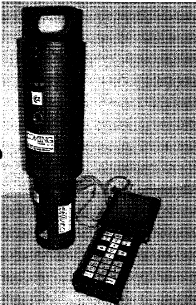
◀ Obr. 5: Odtrhový přístroj COMTEST® OP 3/X
